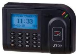
La S300 est une pointeuse de conception récente. Connexion directe sur votre réseau ethernet (câble droit pour un hub ou switch, câble croisé pour le port ethernet de l'ordinateur). Une simple prise 220 v suffit à la pointeuse S300. La lecture se fait par badge sans contact, aucune usure, aucune pièce en mouvement. Les badges existent sous forme de carte classique ou de porte clé.
